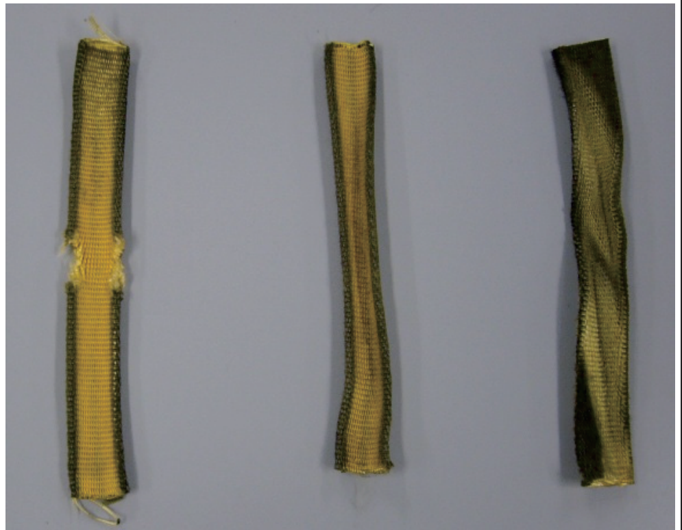
ほつれ・損傷
